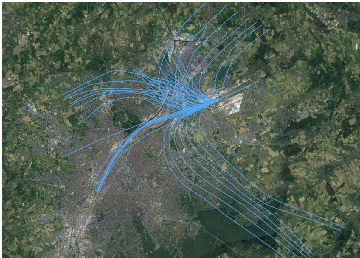
Figure 51 : Backbone tracks et subtracks – départs piste 25R
