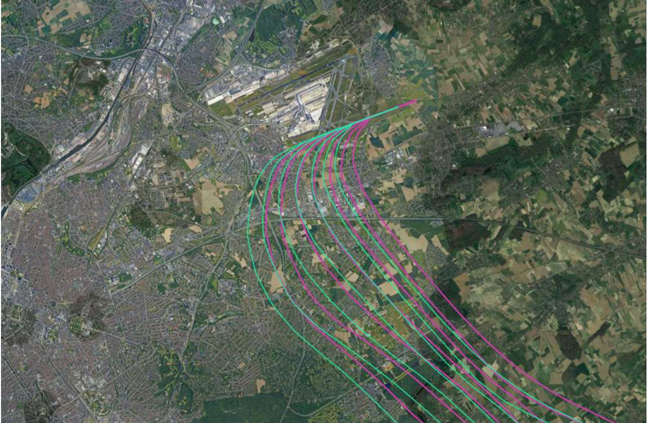
Figure 110 : Backbone track et subtracks pour les départs de la piste 25L avec un virage gauche à 700 ft déplacés de 900 m vers l'Est
