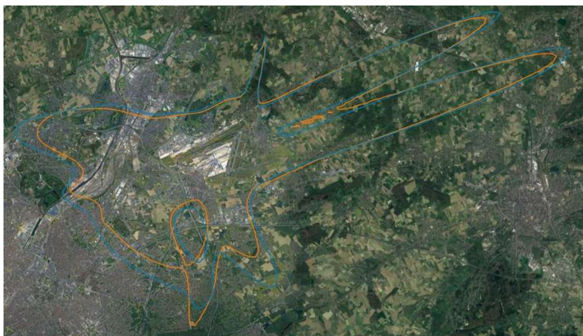
Figure 7 : Contours Lden 55 dB de la base 2019 (orange) et de la période de travaux sur la balise BUB (bleu)
