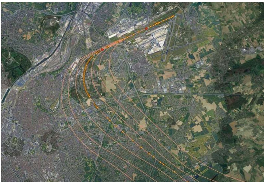
Figure 80 : Backbone track et subtracks de la piste 25R avec les altitudes pour un virage à 1700 ft
